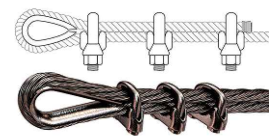
Общий вид петли канатной стропы /General view of the rope slings loop
